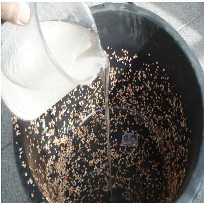
Die richtige Menge des Bindemittels ist 4 % des Marmorgewichts. Auf keinen Fall mehr verwenden, da PU sonst aufschäumt, außer bei S316 darf mehr verwendet werden.
