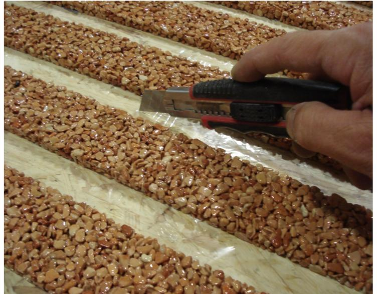
Die Folie zwischen den Teilen mit einem Teppichmesser durchtrennen und die Teile mit der Folie auf ein Holzbrett (Dachlatte) stapeln. Die Folie erst bei der Montage abziehen, diese Verhindert ein Zusammenkleben, falls das Bindemittel noch nicht ausgehärtet ist.
