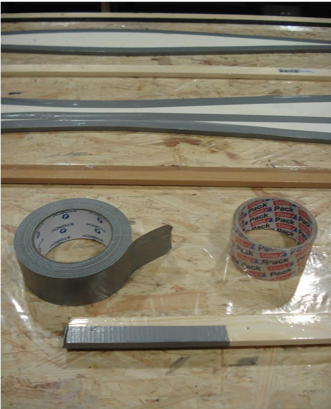
Falls Sie Holzleisten für den Formenbau verwenden, müssen diese mit Klebeband überzogen werden, damit das Bindemittel nicht am Holz festklebt. Abmessungen der Leisten 10 x 30 x 2000 mm. PE-Leisten müssen nicht überklebt werden, da PE-Materialien sich kleben lassen.
