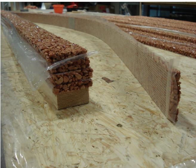
Die fertigen Teile auf einem Holzbrett mit Klebeband sichern. Damit ist gewährleistet, das die Teile gut auf der Baustelle ankommen.
