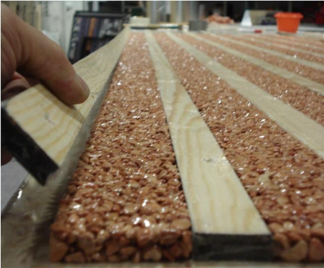
24 Stunden später können die Holzleisten entfernt werden. Da diese trotz Klebeband oder Trennmittel, leicht festkleben können, kann man mit etwas Kraft und Verdrehen die Leisten lösen.
